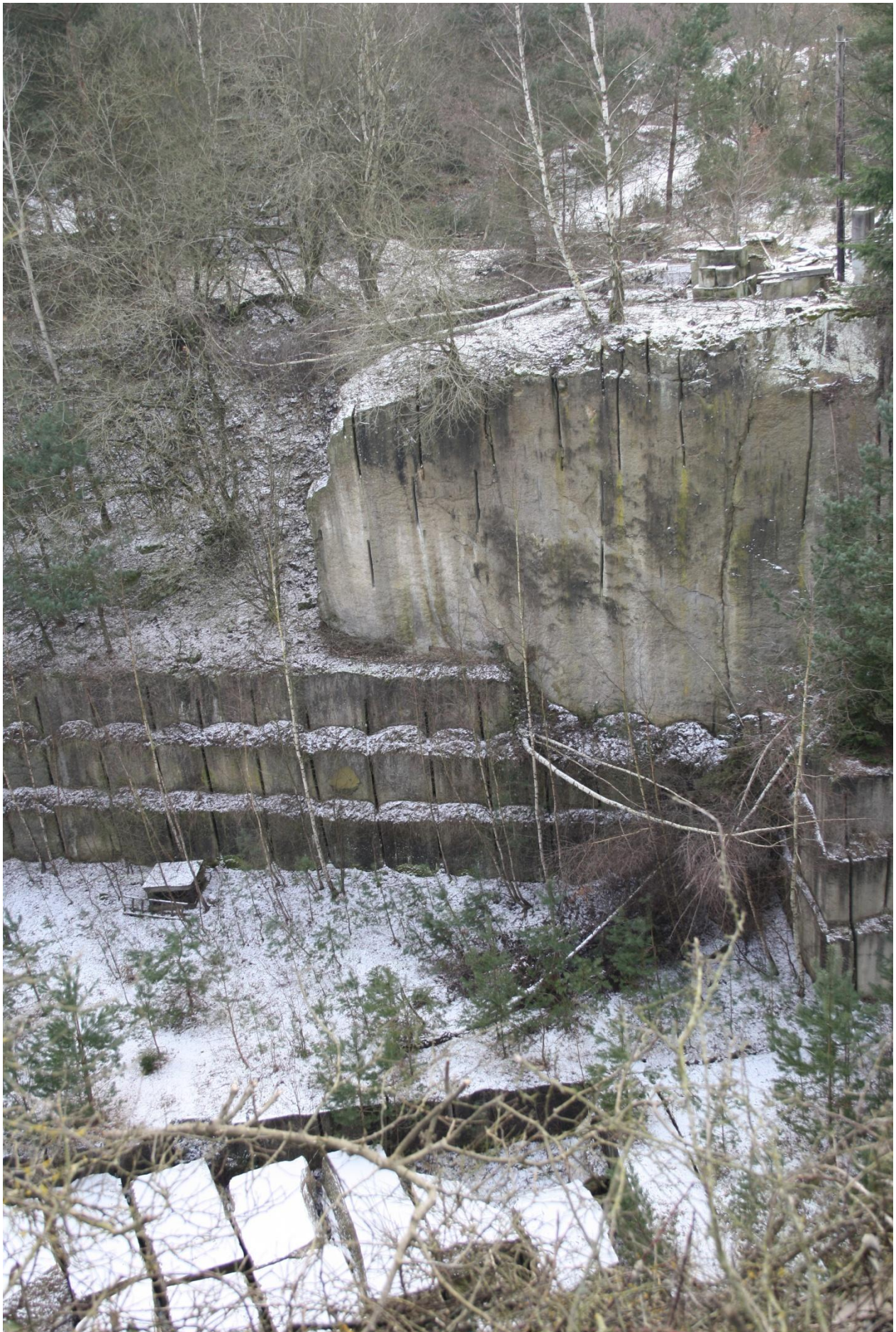
Abb. 52 Ettringen, Rodderhöfe, aufgelassener Kesselbruch mit Schrämschnitten im Tufflager
