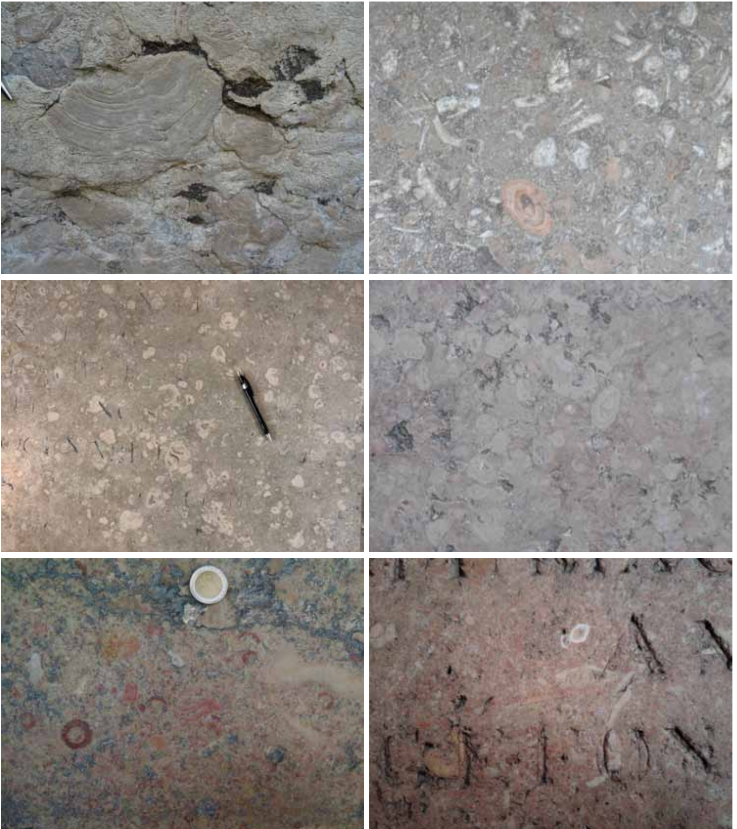
▲ Abb. 3: Beispiele für verschiedene Fazies von Gotland-Kalkstein. Oben links: Fazies mit grauen bis beige-weißen bis gelben Kalksteinen mit dezi-metergroßen Stromatoporen, oft mit sehr gut erhaltenen inneren Strukturen und häufig mit einem rosa bis orangefarbenen Farbton (Nikolaikirche, Rostock). Oben rechts: Fazies mit grünlich-grauen bis gelben Mudstones und Wackestones mit zahlreichen weißen Muschelfossilien, manchmal mit einem orangefarbenen Farbton (Heiligen Geist Hospital, Lübeck). Mitte: Fazies mit grau-grünen bis gelben Kalksteinen, reich an bis zu einigen Zenti-metern großen Onkolithen, oft um Muschelfragmente (St. Salvatorkirche, Brügge, BE) und Algen (Sphaerocodium, St. Walburgiskirche, Zutphen, NL) herum gebildet. Unten: Fazies mit gelbem bis grauem Kalkstein mit zahlreichen leuchtend roten Crinoiden und manchmal großen Stromatoporen, der sogenannte Hoburger Marmor (Liebfrauen-Kirche, Brügge und Liebfrauenkirche, Lissewege, BE).
